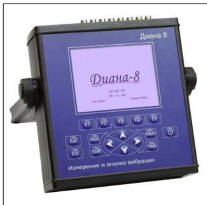
Восьмиканальный синхронный регистратор-анализатор вибросигналов «ДИАНА-8» предназначен для решения практических задач диагностики состояния оборудования.
