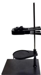
**Штатив универсальный ШУ-05** предназначен для крепления измерительных и вспомогательных электродов, автоматических термокомпенсаторов и термометров при проведении анализов растворов.
