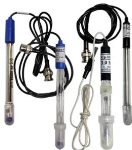
Потенциометрические методы анализа основаны на измерении потенциала электрода, погруженного в анализируемый раствор. Для измерения потенциала используют гальванический элемент, состоящий из индикаторного электрода и электрода сравнения.
