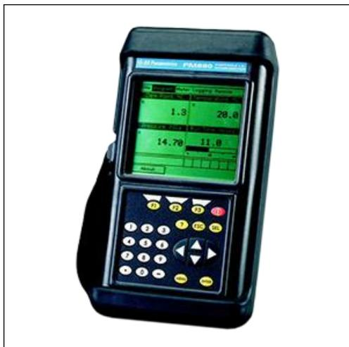
PM880 - целостная портативная система-гигрометр для измерения содержания влаги в промышленных газах и жидкостях. Проверенный датчик влажности из оксида алюминия позволяет PM880 выводить на большой жидкокристаллический экран влажность в точке росы (°C или °F), ppmv, ppmw, lb/MMSCF (фунты воды на миллион кубических футов природного газа при нормальных условиях), и ряд других параметров. Данные можно выводить на экран в буквенно-цифровом либо графическом формате.
