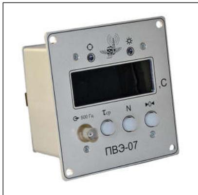
Электронный секундомер «ПВЭ -07» предназначен для измерения интервалов времени срабатывания и отпускания реле и других контактных устройств, формирования среднего значения по результатам нескольких измерений, подсчета числа измерений и индикации результатов в цифровой форме.
