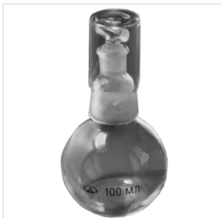
Предназначены для инкубации проб воды при определении биохимического потребления кислорода.
