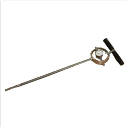
Пенетрационный плотномер В предназначен для ускоренного операционного контроля качества уплотнения (коэффициента уплотнения) грунтов при строительстве земляного полотна автомобильных и железных дорог, аэродромов и других грунтовых сооружений.
