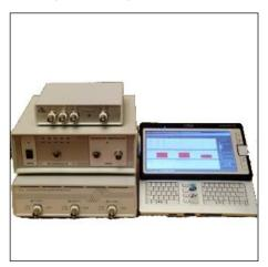
Установки «Импульс-9» являются развитием установок «Импульс-8», широко применяемых в России и СНГ для оценки механического состояния обмоток силовых трансформаторов и реакторов.
