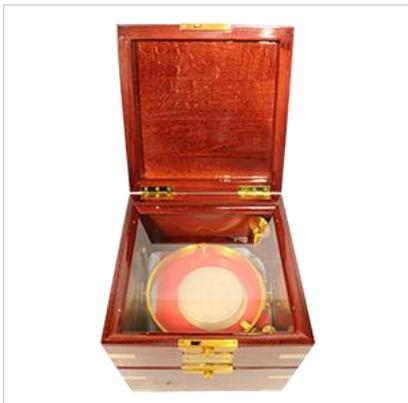
Хронометр 6МХ разработан в 1947 году и предназначался для хранения точного времени в часах, минутах и секундах на кораблях и судах всех классов, типов и назначений. С 1949 года начался промышленный выпуск морских хронометров, который продолжается до настоящего времени. Морской хронометр экспортировался в Болгарию, Вьетнам, Германию, Польшу, Румынию, Финляндию, Чехословакию, Югославию, Японию, Италию, Америку и другие страны.
