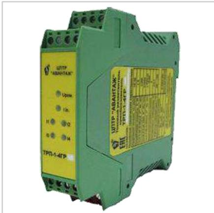
Преобразователи-разветвители унифицированных сигналов ТРП-1-4ГР предназначены для подключения датчиков с выходными сигналами 0-20 (4-20) мА по 2-х или 3-х проводной схеме, или сигналов 0-5 (0-10) В с последующим разветвлением с преобразованием или без него на 4 идентичных сигнала.
