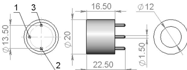
Рис.1 Размеры сенсора и схема расположения выводов
