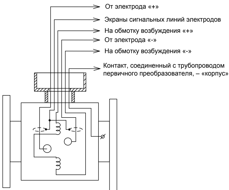
Рисунок Д.1 Общая схема первичного преобразователя расхода
