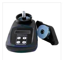
Влагомер SUPERPRO применяется для экспрессного анализа влажности зерна в лабораторных и полевых условиях, при уборке, хранении и переработке зерна, при послеуборочной обработке и сушке зерна, на токах, при размещении зерна в хранилищах; при увлажнении зерна перед помолом.
