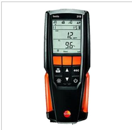
Testo-310 представляет собой портативный измерительный прибор, предназначенный для анализа дымовых газов систем сгорания. Оснащен двумя сенсорами - O<sub>2</sub> и CO, а также сенсором температуры, интегрированным в зонд отбора пробы. Сенсоры газа измеряют содержание кислорода и угарного газа, а также температуру дымовых газов и окружающей среды. На основе этих значений прибор рассчитывает - концентрацию CO<sub>2</sub>, КПД и потери тепла с дымовыми газами.
