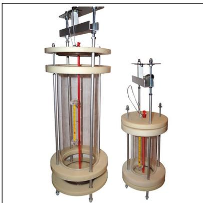
Батометр Рутнера предназначен для взятия проб воды в водохранилищах и озерах при исследовании, например, микроэлементного состава придонных вод.
