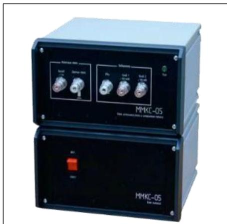
Комплекс предназначен для определения магнитных характеристик сердечников, изготовленных из магнитомягких материалов (аморфных сплавов, прецизионных сплавов, электротехнических сталей), а также накопления и обработки результатов измерений. Комплекс обеспечивает определение статических магнитных характеристик в соответствии с ГОСТ 8.377 и ГОСТ 12119.1.
