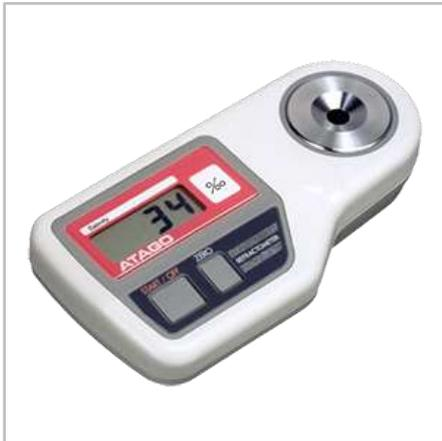
Ручной цифровой рефрактометр PR-100SA серии Palette специально разработан для измерения солености морской воды (‰).
