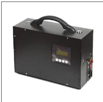
Прибор ПА-300М-3 предназначен для отбора разовых проб воздуха рабочей зоны и атмосферы на загрязненность (пыль, газы, аэрозоли).
