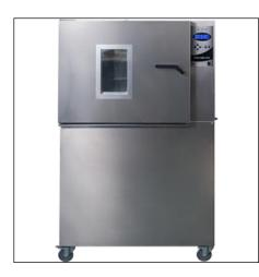
Предназначена для испытания изделий, образцов, в условиях циклических изменений температуры от низкой до высокой, в т.ч. с возможностью подачи на испытуемые изделия электропитания.
