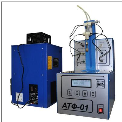
Аппарат **АТФ-01** служит для автоматического контроля качества нефтепродуктов, преимущественно дизельных и печных топлив, по предельной температуре фильтруемости на холодном фильтре в соответствии с ГОСТ 22254, ASTM D6371, IP 309 и EN 116.
