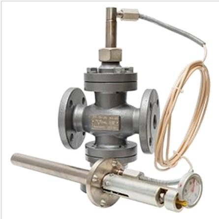
Регуляторы температуры прямого действия трехходовые дистанционные РТ-ТР предназначены для автоматического регулирования температуры в нагревательных и охлаждающих системах бытовых, коммунальных и промышленных установок путем изменения расхода жидких сред, неагрессивных к материалам регулятора.
