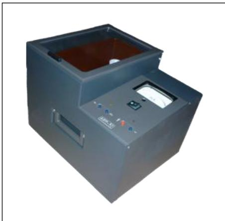
Высоковольтная установка АИМ-92 предназначена для определения пробивного напряжения трансформаторного масла и других жидких диэлектриков,  $U=92$ кВ.
