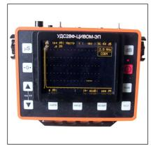
Прибор для ультразвуковой диагностики структуры высоковольтного фарфора **УДС 2ВФ-ЦИВОМ-ЭП** предназначен для измерения временных интервалов при неразрушающем контроле опорностержневых фарфоровых изоляторов и фарфоровых покрышек в соответствии с методикой «Ультразвуковой неразрушающий контроль высоковольтных фарфоровых изоляторов на монтаже, в эксплуатации и у изготовителя. Методика проведения контроля».
