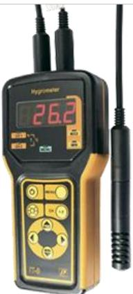
Термометр-гигрометр IT-8-RHT представляет собой цифровой портативный измеритель температуры IT-8.
