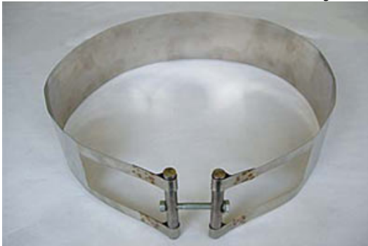
1 - лента, 2 - стержни с отверстиями, 3 - шайба, 4 - гайка, 5 - болт
