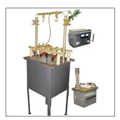
Установка УИ-70 C3 на 15кВ и 50 кВ предназначена для испытаний электрозащитных средств, используемых в электроустановках.
