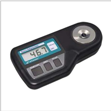
Ручной рефрактометр PR-BUTYRO серии Palette предназначен для исследования жировой фракции на детектирование растительных добавок. Прибор идеально подходит для исследования сливочного, топленого и любого другого пищевого масла.
