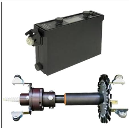
Специализированный дефектоскоп предназначен для контроля трещин, пористости, недопустимых утонений и других нарушений целостности защитных покрытий внутри труб при выходном и входном контроле в условиях мелкосерийного производства, а также при монтаже трубопроводов, применением импульсного высоковольтного напряжения и фиксацией электрического пробоя в местах нарушения целостности.
