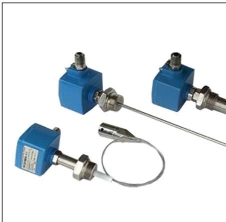
Уровнемер ПУМА100 (емкостной преобразователь уровня) предназначен для непрерывного измерения уровня жидких или сыпучих сред в технологических и товарных резервуарах, танках, силосах, бункерах и т.п. стационарных установках, в том числе в емкостях, находящихся под избыточным давлением. Также используется для передачи измерительной информации по интерфейсу RS-485 другим устройствам систем автоматизированного управления (АСУ).
