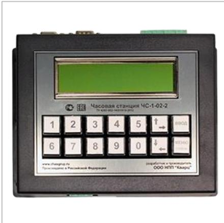
Часовая станция ЧС-1-02-2 предназначена для построения небольших и средних систем единого времени. После отключения/включения питающей сети подгон времени на вторичных часах осуществляется автоматически. Определение високосного года и переход на летнее/зимнее время также происходят автоматически. Сохранение хода времени и установочной информации при отключении питания до 1 года.
