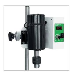
Устройства используются для перемешивания невязких жидкостей в колбах, стаканах, бутылях и других емкостях. Применяется для приготовления эмульсий и дисперсий в косметической и фармацевтической лабораториях.
