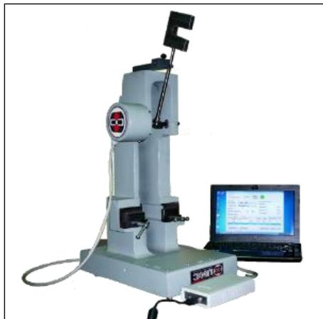
Копер предназначен для определения ударной вязкости пластмасс при двухопорном ударном изгибе по методу Шарпи в соответствии с ГОСТ 4647. Испытываемые образцы по ГОСТ 4647.
