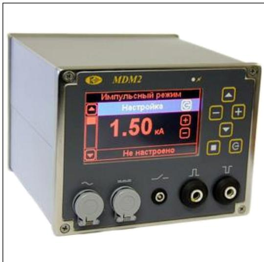
Дефектоскоп предназначен для проведения неразрушающего контроля изделий из ферромагнитных материалов с относительной магнитной проницаемостью не менее 40. Используется для контроля в авиационной, автомобильной, железнодорожной и других видах техники магнитопорошковым методом с целью выявления поверхностных и подповерхностных дефектов в их материале. Он относится к переносным специализированным средствам контроля и рассчитан для работы в цеховых, лабораторных или полевых условиях.
