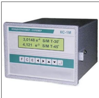
Программируемый кондуктометрический солемер «КС-1М-1» предназначен для непрерывного контроля удельной электрической проводимости (УЭП) жидких сред в том числе для контроля солесодержания в насыщенном и перегретом паре, котловой воде, конденсате, степени очистки воды в цехах водоподготовки и других производств.
