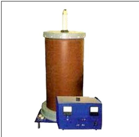
Установки высоковольтные предназначены для диагностирования изоляции силовых трансформаторов и кабелей, а также для применения в лабораторных и производственных процессах.
