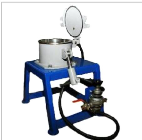
55СГ сгуститель суспензий Предназначен для сгущения суспензий плотностью до 5 г/см<sup>3</sup> в лабораторных условиях.
