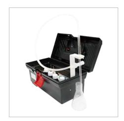
Тест-комплект «Общая жёсткость КВ» предназначен для экспресс-определения общей жёсткости (суммарной молярной концентрации эквивалентов катионов кальция и магния) в пресных технических водах — исходной, сетевой, подпиточной, питательной, составляющих ее конденсатах, в котловых, циркулирующих в системах охлаждения и теплофикационных водах (РД 24.031.120-91, РД 24.032.01-91 и РД 34.37.523.8-88).
