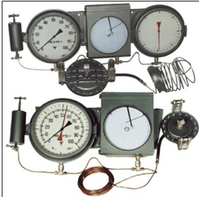
Гидравлический индикатор веса «ГИВ6 М2» предназначен для измерения и регистрации усилий натяжения неподвижного конца талевого каната при бурении и капитальном ремонте скважин. В зависимости от назначения индикатор выпускается в семи модификациях, различающихся типом трансформатора давления и составом вторичных приборов:
