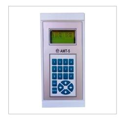
Термометр почвенный АМТ-5 предназначен для измерений температуры почвы на разных глубинах в метеорологических наблюдательных подразделениях, а также для измерений температуры сыпучих, газообразных и жидких сред.
