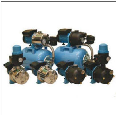
Система водоснабжения «ДЖАМБО-ДОМ» предназначена для автоматической подачи воды в жилой комплекс. Система состоит из следующих основных частей: поверхностного насоса серии ДЖАМБО, имеющего встроенный контроллер управления, гидроаккумулятора и датчика давления. В комплект поставки также входит соединительная арматура.
