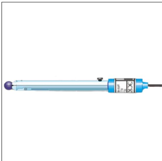
Предназначен для большинства случаев лабораторного анализа. Обеспечивает высокую скорость отклика. Подходит для измерений при пониженной, а также изменяющейся в широких пределах температуре. Двухключевое исполнение встроенного электрода сравнения позволяет применять для его заполнения не только растворы КСl, но и другие электролиты в тех случаях, когда нежелательно попадание ионов К<sup>+</sup> и/или Сl<sup>-</sup> в анализируемый раствор.
