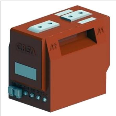
Однофазные трансформаторы тока ТОЛ-10М по принципу конструкции являются опорными, с литой изоляцией. Трансформатор может содержать до 4-х вторичных обмоток, каждая из которых расположена на своем магнитопроводе.
