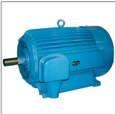
Трехфазные общепромышленные асинхронные электродвигатели ремонтной серии **АО10** с короткозамкнутым ротором предназначены для продолжительного режима работы от сети переменного тока. Форма исполнения IM 1001, IM 1002. Высота оси вращения 400 мм.
