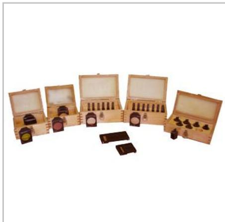
КНФ-1-01 наборы мер предназначены для использования в качестве рабочих эталонов спектрального коэффициента направленного пропускания (в дальнейшем - СКНП), интегрального коэффициента пропускания, спектральной и интегральной оптической плотности и длины волны при поверке (калибровке) фотометрической шкалы и шкалы длин волн фотометров и спектрофотометров.
