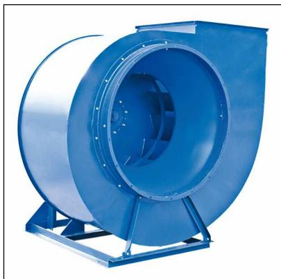
ВР-80-75 электровентилятор низкого давления обладает компактной конструкцией корпуса из оцинкованной стали (№№ 2,5-6,3) или из углеродистой стали окрашенные (№ 8,0 и более), с 13 лопатками, загнутыми назад. Электровентилятор имеет трехфазный асинхронный двигатель (380 В), класс защиты электродвигателя IP 44.
