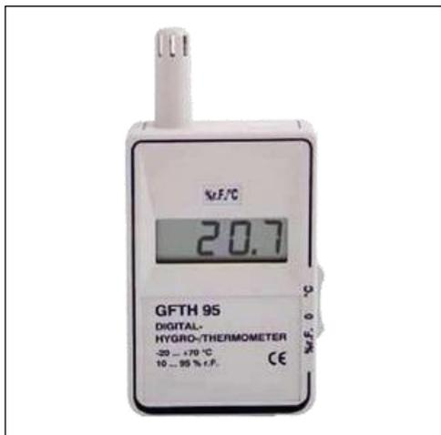
Цифровой гигрометр-термометр GFTH-95 предназначен для мгновенного измерения влажности воздуха и температуры в помещениях, где производится электронная обработка данных, музеях, галереях, церквях, административных, жилых и складских помещениях, в теплицах, бассейнах, производственных помещениях, в холодильной технике и технике кондиционирования воздуха, для экспертизы строительных сооружений, строительной физики и экспертизы по оценке ущерба.
