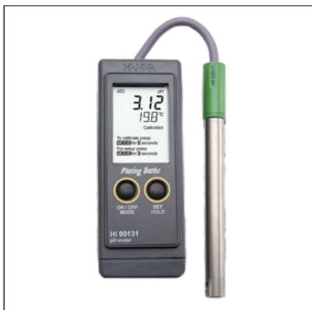
Прибор в пыле- и водонепроницаемом корпусе (IP 67) с выносным (сменным) электродом предназначен для точного измерения рН и температуры для гальванических ванн. С автоматической термокомпенсацией и ручной калибровкой рН по 2 точкам.
