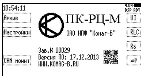
Левый блок меню позволяет перейти к работе с Архивом, Настройками прибора, а также войти в режим CAN монитора.
