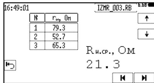
При этом в строке статуса отображается имя открытого файла: IZMR\_002.UI. Кнопки и позволяют переходить к предыдущему или следующему файлу в текущей папке соответственно. Назначение остальных кнопок аналогично назначению этих же кнопок в соответствующем режиме измерения. (См. п. 7.1 и 7.3).
