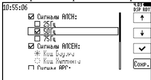
Кнопки **↑** и **↓** позволяют перемещать курсор по списку, кнопкой **✓** производится изменение состояния элемента списка (выбран или не выбран). По окончании редактирования необходимо нажать кнопку **СОХР.** В случае наличия противоречий в выбранных сигналах, при нажатой кнопке **СОХР.** появится сообщение об ошибке. Для сохранения настроек противоречие необходимо исключить.
