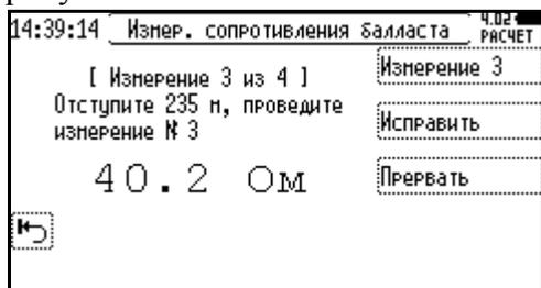
После подключения к рельсам и получения устойчивого результата нажать кнопку  $\text{Измерение 3}$  для его фиксации. В случае ошибки возможна отмена предыдущего измерения кнопкой  $\text{Исправить}$ . Если необходимо провести меньшее количество промежуточных измерений, чем рекомендовано прибором, нажать кнопку  $\text{Прервать}$  для досрочного перехода к третьему этапу.
