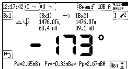
Опорный вход выбирается кнопкой выбора активного входа  $\boxed{\text{Вх1}} \rightarrow \boxed{\text{Вх2}}$ . Активный вход является опорным. Т.е. относительно него рассчитывается разность фаз на частоте, преобладающей на опорном входе.
