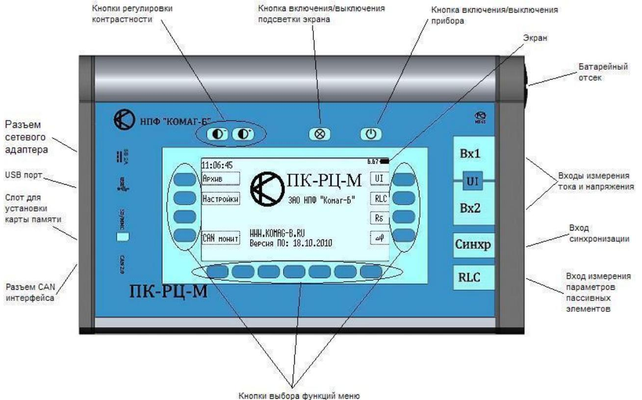
На передней панели прибора в верхнем ряду расположены кнопки включения прибора, управления подсветкой и регулировки контрастности экрана.
