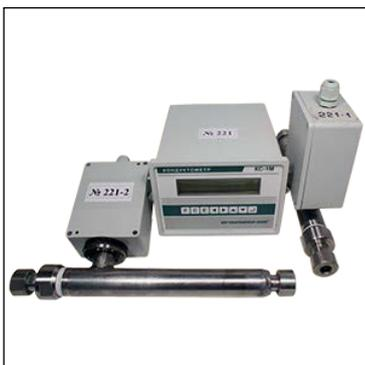
Программируемый кондуктометрический солемер «КС-1М-2» предназначен для непрерывного измерения удельной электрической проводимости (УЭП) жидких сред в т.ч. для контроля солесодержания в насыщенном и перегретом паре, котловой воде, конденсате, степени очистки воды в цехах водоподготовки и других производств. Прибор проточного исполнения выпускается в модификации КС-1М-2: одноканальный с 4-х электродным ПП с диапазоном измерения от 50 до 100000 мСм/м и температурой измеряемой среды от 0 до 100 °С.
