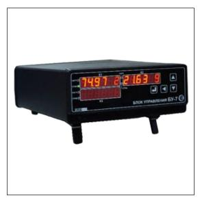
Предназначен для измерения и поддержания температуры в рабочем пространстве (объеме) средств поверки преобразователей температуры (печей термостатов и др.), управляя подводимой электрической мощностью.
