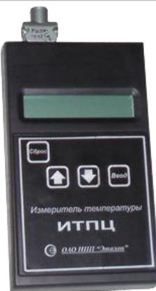
Измерители температуры портативные цифровые ИТПЦ предназначены для измерения температуры с возможностью сохранения измеренных значений во внутренней энергонезависимой памяти и передачи их в ЭВМ. Приборы, в зависимости от варианта исполнения, работают с термопреобразователями сопротивления по ГОСТ Р 8.625-2006 или преобразователями термоэлектрическими (термопарами) по ГОСТ Р 8.585-2001 любой конструкции.
